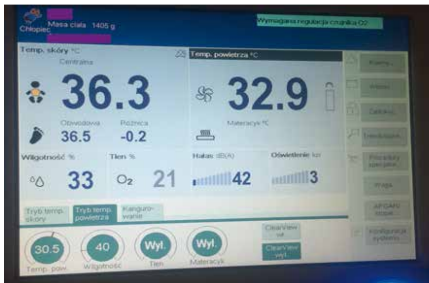
Ryc. 2. Monitorowanie natężenia dźwięku bezpośrednio w inkubatorze.
