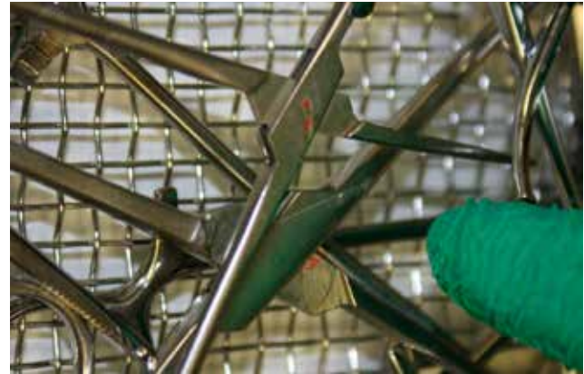
Ryc. 4. Pozostałości wskaźnika testowego na narzędziach mytych w myjni-dezynfektorze bez dezynfekcji wstępnej.
