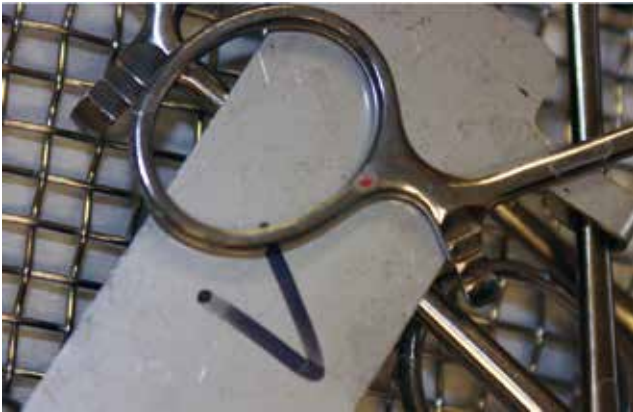
Ryc. 3. Pozostałości wskaźnika testowego na narzędziach mytych w myjni-dezynfektorze bez dezynfekcji wstępnej.
