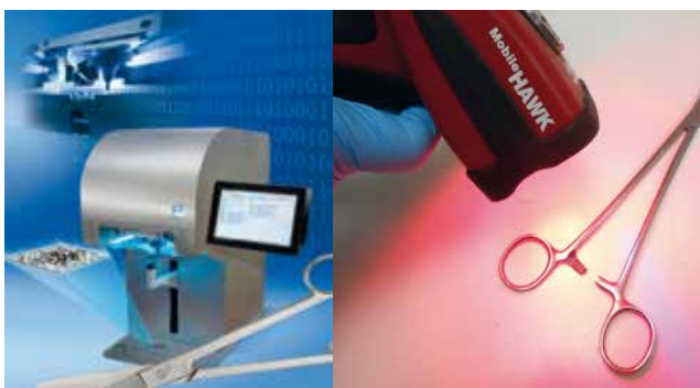
Ryc. 7. Znakowanie narzędzi kodem 2D Data Matrix z zastosowaniem metody laserowej [12]. Po stronie lewej – urządzenie do nanoszenia kodu metodą laserową. Po prawej stronie – skanowanie kodu 2D Data Matrix specjalnym skanerem 2D. W ramach systemu informatycznego funkcjonuje oprogramowanie 2D, które umożliwia racjonalne gospodarowanie oznakowanymi narzędziami.
