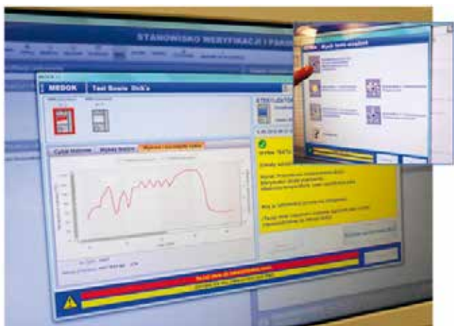
Ryc. 3. Test Bowie-Dicka – kwalifikacja procesu (C.S., Instytut Onkologii, Gliwice). Po lewej stronie okna jest widoczny wykres cyklu Bowie-Dicka. Prawidłowy przebieg cyklu powinien być potwierdzony pozytywnym wynikiem testu Bowie-Dicka. Odczytu dokonuje się manualnie i zatwierdza według instrukcji ekranowej widocznej po prawej stronie.
