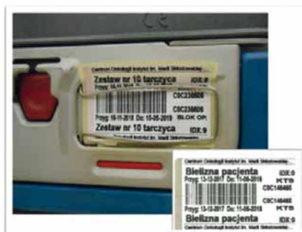
Ryc. 5. Etykiety obieguowe (C.S., Instytut Onkologii, Gliwice). Rycina przedstawia dwie dwuczęściowe, dwustronnie przyklepne etykiety obieguowe z widocznymi kodami kreskowymi i cyfrowymi: jedna, z kodem COC236606 oznakowuje kontener z zestawem zabiegowym, druga, z kodem COC146465 – pakiet z bielizną pacjenta. Kody udostępniają dane archiwalne przechowywane w systemie informatycznym zawierające informacje o historii obiegu oznakowanych narzędzi.
