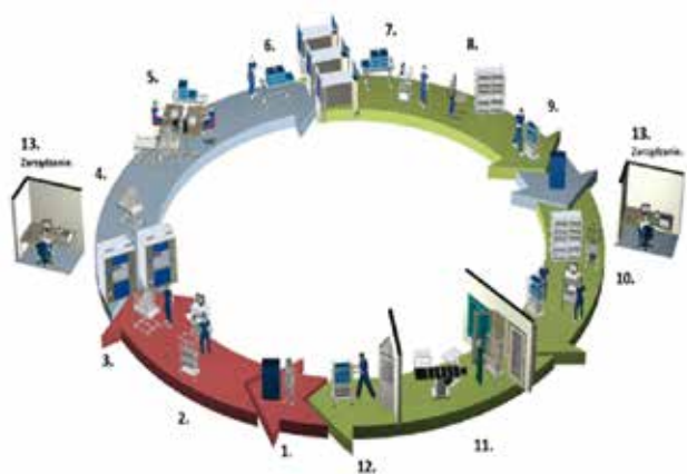
Ryc. 1. Schemat systemu informatycznego do zarządzania centralną sterylizatornią, zintegrowanego z systemem dla bloku operacyjnego [13]. W centralnej sterylizatorni wydzielono: w strefie brudnej stanowiska 1, 2, 3, w strefie czystej stanowiska 4, 5, 6, w strefie sterylnej stanowiska 7, 8, 9, 10, w bloku operacyjnym stanowiska 11, 12, a także dwa stanowiska zarządzania 13.
