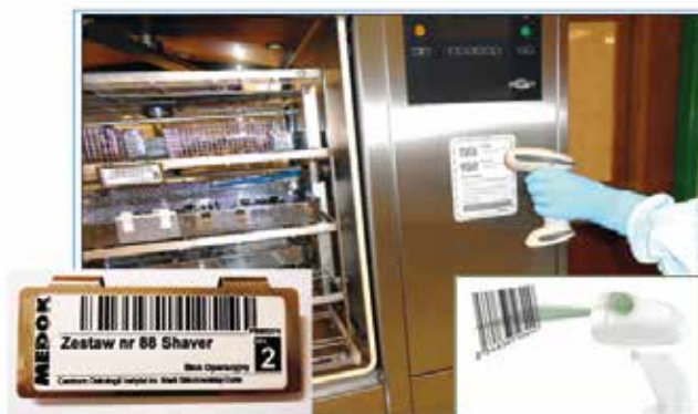
Ryc. 2. Procedura załadunku i uruchomienia procesu w myjni-dezynfektorze (C.S., Instytut Onkologii, Gliwice). Po kompletacji wsadu jest uruchamiany cykl zgodnie z instrukcją karty komend z kodami kreskowymi. Kody kolejno są skanowane celem zatwierdzenia wykonanych czynności. W lewym dolnym rogu ryciny znajduje się oznacznik z etykietą z kodem kreskowym identyfikującym zestaw nr 88 Shaver, indeks 2.
